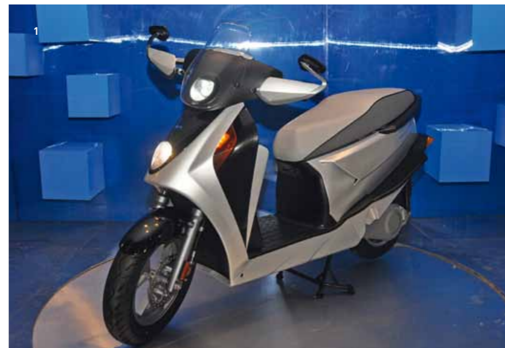
(1) Der Hero Leap fährt elektrisch, aber in Notfällen auch mit dem kleinen Range Extender
