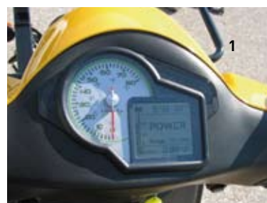
[1] Die verbleibende Reichweite wird als Ladestandsbalken und auch als Kilometerangabe angezeigt [2] Das Ladegerät ist eingebaut. Wir bekamen auch einen italienischen Campingstecker mitgeliefert ... [3] So soll die Kundenversion für Firmenflotten aussehen
